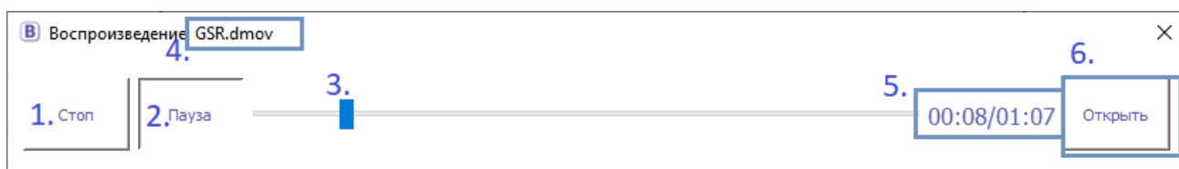
Рисунок 5 - Воспроизведение записанных данных: 1 – остановка/перезапуск, 2- пауза, 3 – индикация прогресса и перемещение по времени воспроизведения, 4 – имя текущего файла, 5 – текущее время воспроизведения и общая длительность записи, 6 – открыть новую запись
