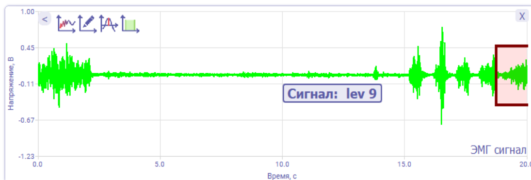
Рисунок 35 - Принцип действия элемента «Триггер по размаху кривой»
